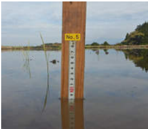
くい打ち法による計測
